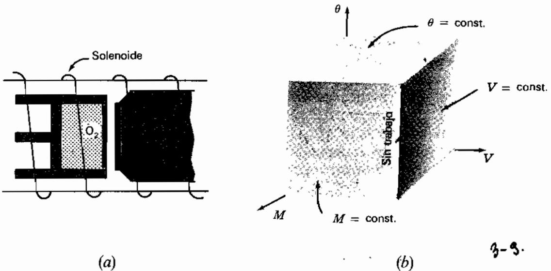
Figura 3.9. (a) Sistema compuesto cuyas coordenadas son  $P, V, \mathcal{H}, M$  y  $\theta$ . (b) Gráfica de las coordenadas independientes  $\theta, V$  y  $M$ .
