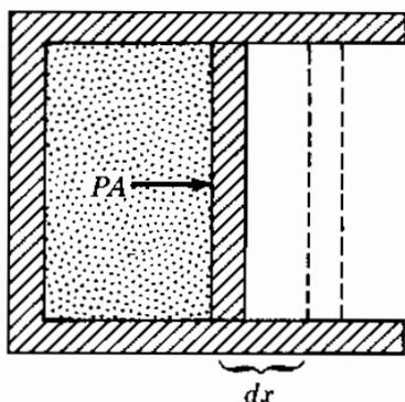
Figura 3.1. Contracción cuasi-estática de un sistema hidrostático.
